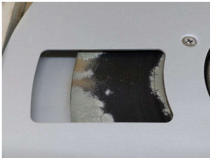
カビが発生したテープの例
